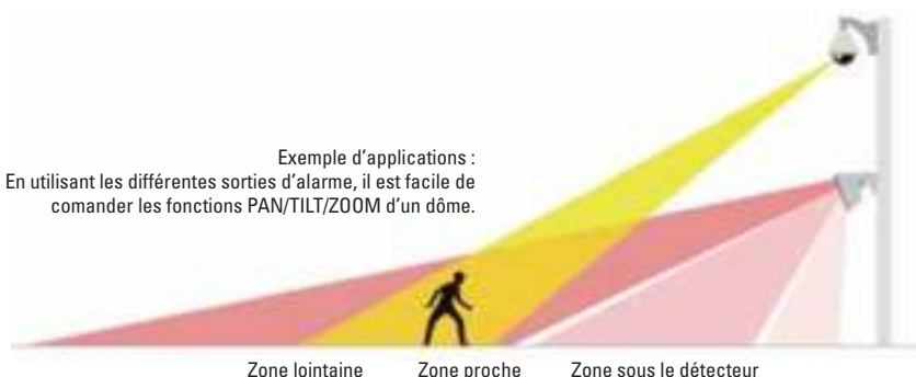
Zone lointaine Zone proche Zone sous le détecteur
